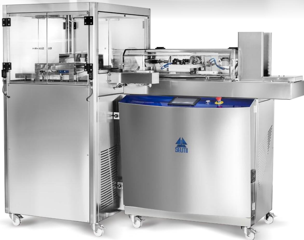
Caricatore automatico per riempimento e vibrazione di stampi in policarbonato con possibilità di realizzare corpi pieni e corpi cavi. (Dimensione stampo 275x175 mm.) Macchina operatrice che necessita di lavorare abbinata ad una temperatrice TOP EX. Il sistema completo risulta di ingombri estremamente ridotti senza rinunciare ad interessanti produttività: circa 6 stampi/minuto per gusci in cioccolato e corpi pieni.
